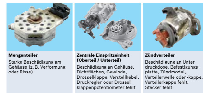
Starke Korrosion Aggregat unvollständig oder zerlegt Mechanische Beschädigung
